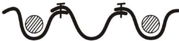
Рисунок 3. Способ установки крестовин на крышу из шифера или рифленого материала
