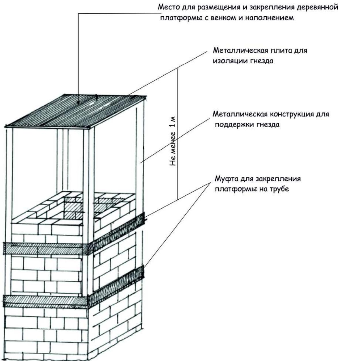
Рисунок 8. Металлическая конструкция под платформу на дымоход
